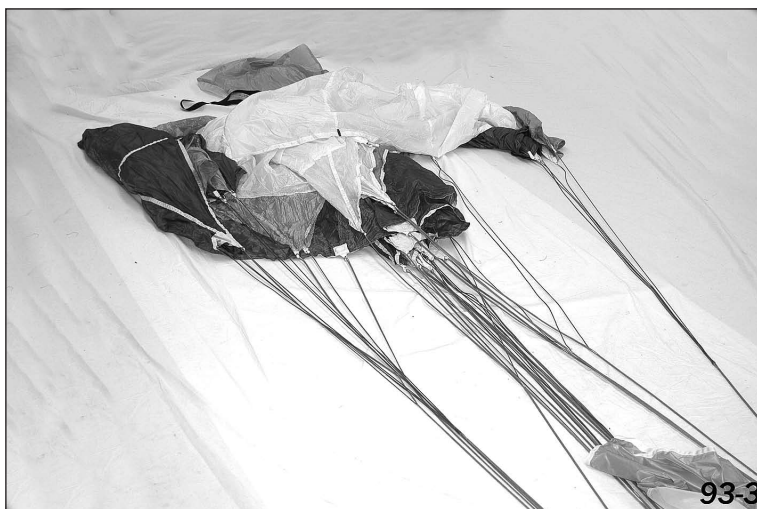
Рисунок 17 – Укладка задней части купола
