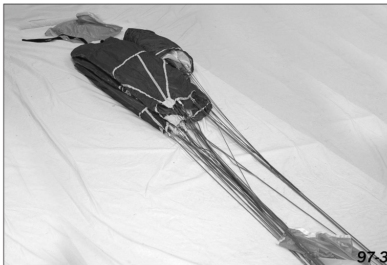
Рисунок 21 - Укладка задней части купола
