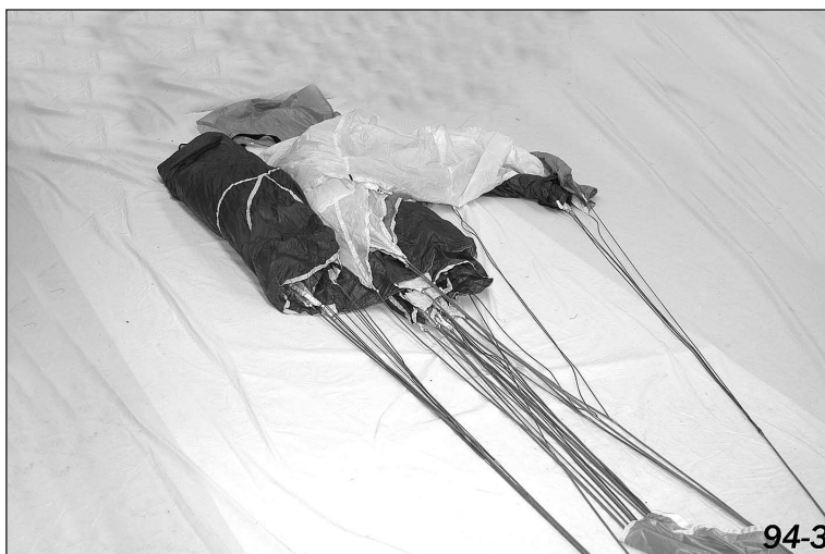
Рисунок 18 – Укладка задней части купола
