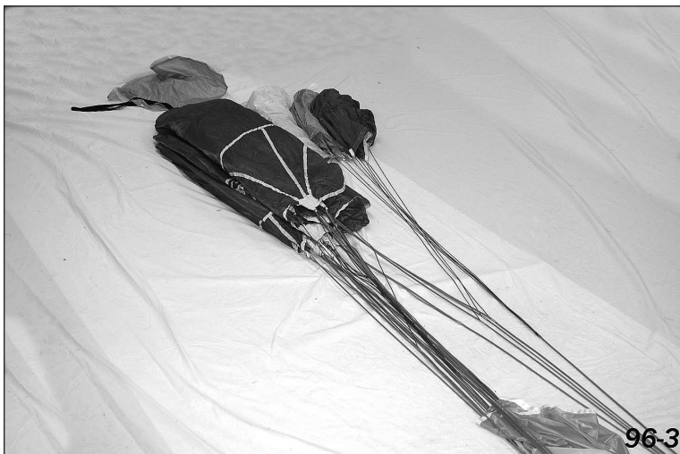
Рисунок 20 – Укладка задней части купола
