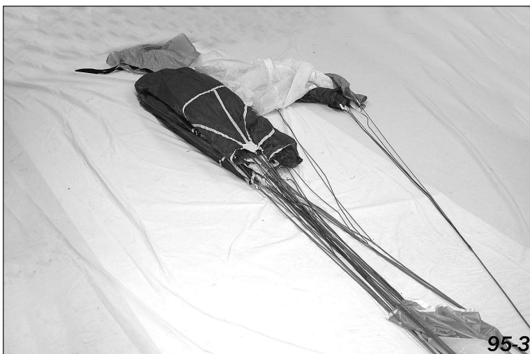
Рисунок 19 - Укладка задней части купола
