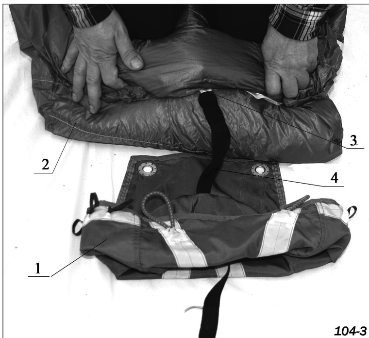
Рисунок 28 - Укладка купола в камеру
