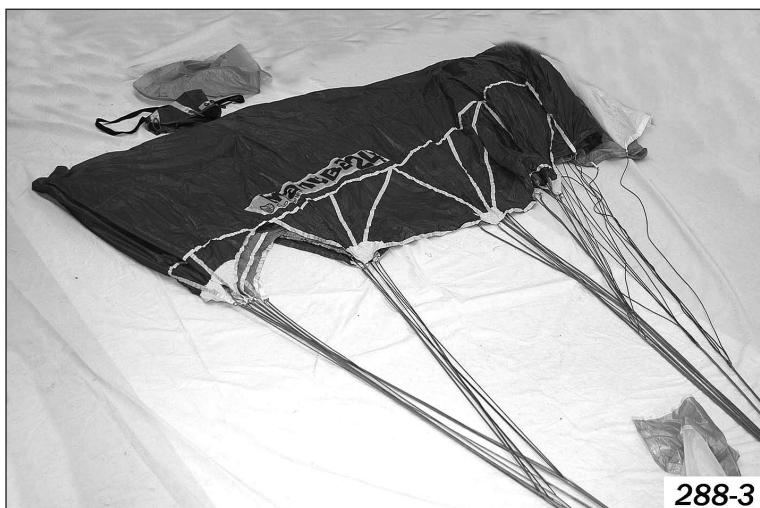
Рисунок 13 – Укладка передней части купола
