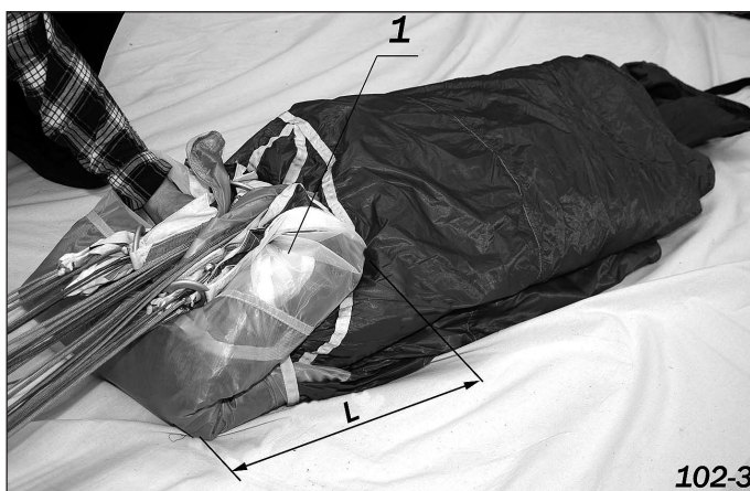
1 – купол в полотнище устройства рифления; L – размер, равный длине камеры.
