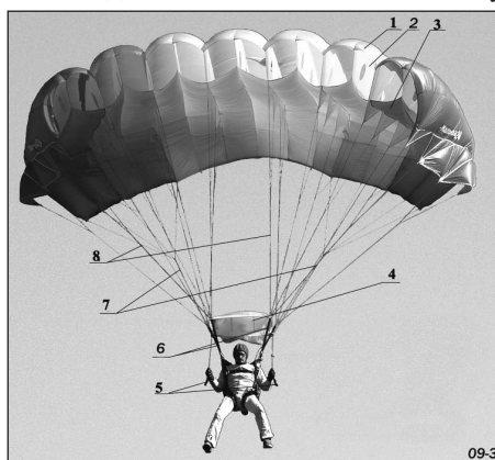
1 – полотнище верхнее; 2 – нивьюра; 3 – полотнище нижнее; 4 – устройство рифления; 5 – звенья управления; 6 – концы свободные; 7 – стропы управления; 8 – стропы.
