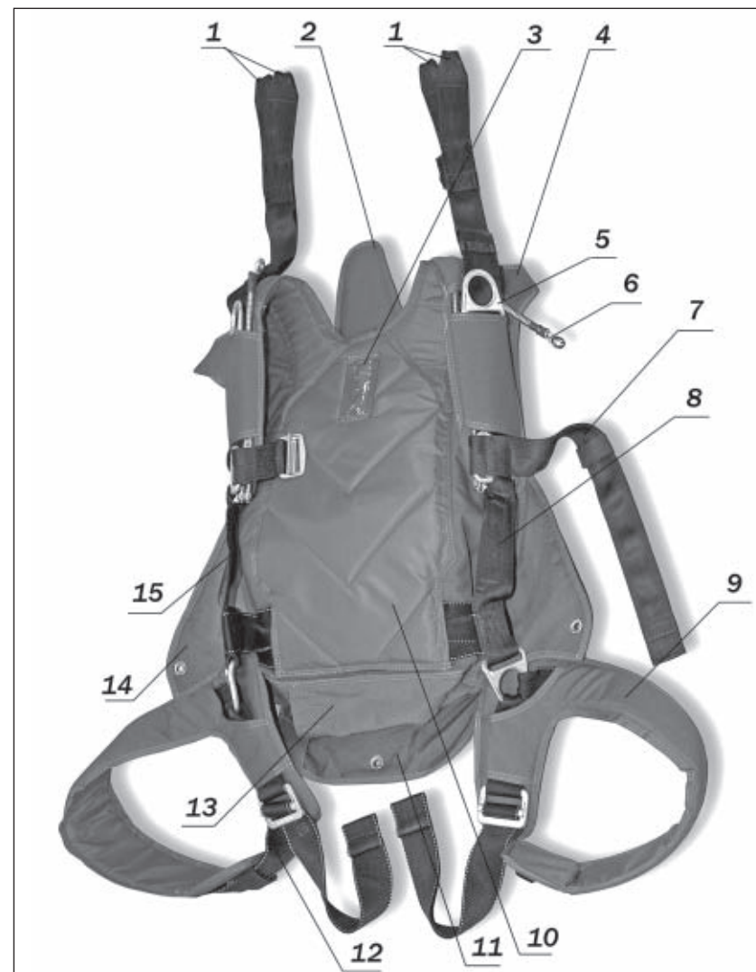
1 – концы свободные запасного парашюта; 2 – клапан предохранительный ранца запасного парашюта; 3 – карман на спинке ранца для размещения блока контроля страхующего прибора Суррес; 4 – клапан свободных концов основного парашюта; 5 – пряжка КЗУ; 6 – шланг с наконечником; 7 – переемычка грудная; 8 – карман звена ручного раскрытия; 9 – накладка предохранительная ножного обхвата; 10 – спинка; 11 – клапан нижний отсека основного парашюта; 12 – обхват ножной; 13 – карман вытяжного парашюта; 14 – клапан боковой отсека основного парашюта; 15 – карман звена отсоединения.
