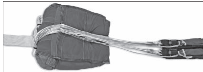
Рисунок 29 – Укладка строп запасного парашюта в камеру
