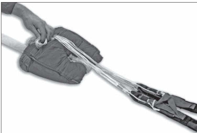
Рисунок 28 – Укладка строп запасного парашюта в камеру
