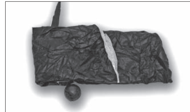
Рисунок 53 – Укладка вытяжного парашюта
