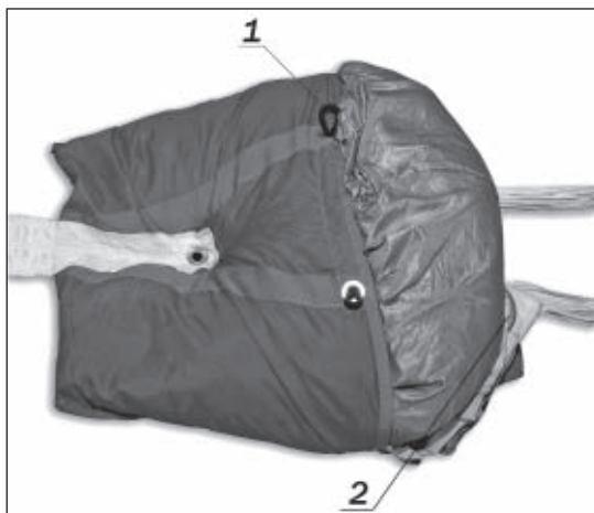
1 – сота резиновая «плавающая»; 2 – люверс устройства рифления.
