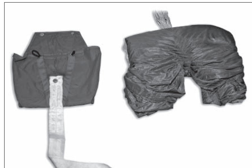
Рисунок 22 – Укладка купола запасного парашюта в камеру
