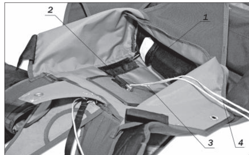
1 – процессорный блок страхующего прибора; 2 – пирорезак страхующего прибора; 3 – зачехловочная петля; 4 – стропу-затяжка.
