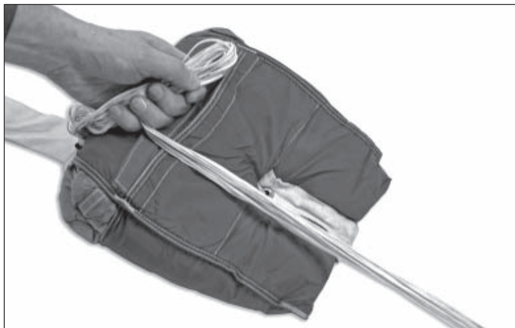
Рисунок 27 – Укладка строп запасного парашюта в камеру
