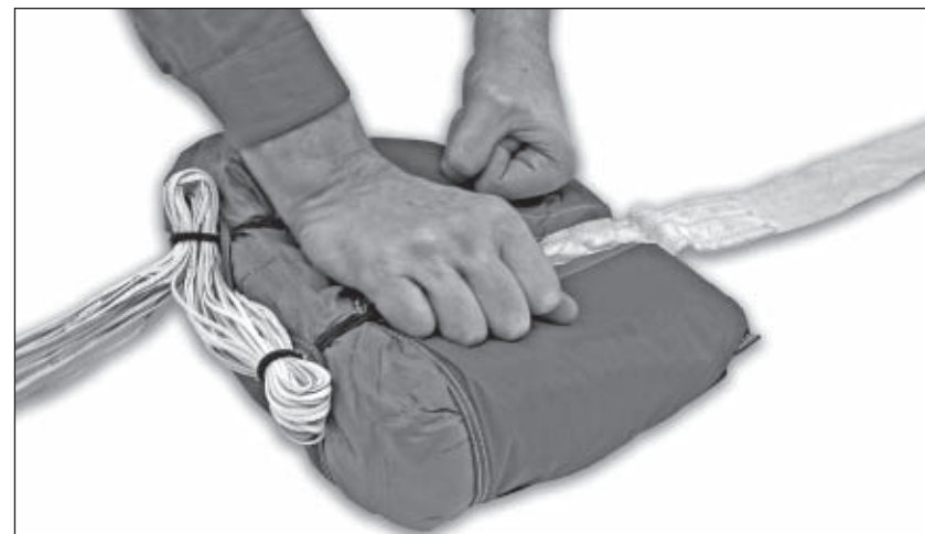
Рисунок 25 – Укладка купола запасного парашюта в камеру
