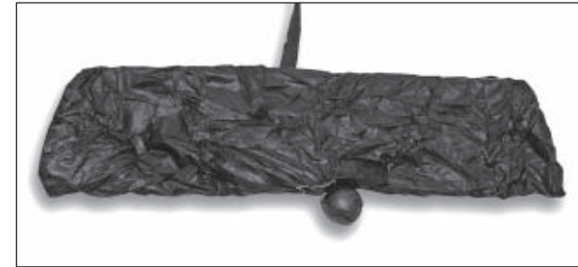
Рисунок 52 – Укладка вытяжного парашюта
