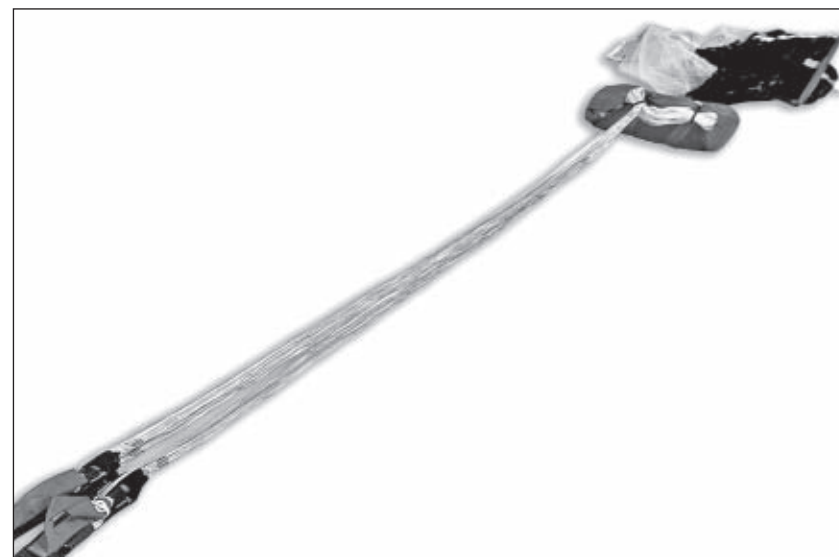
Рисунок 26 – Укладка купола запасного парашюта в камеру
