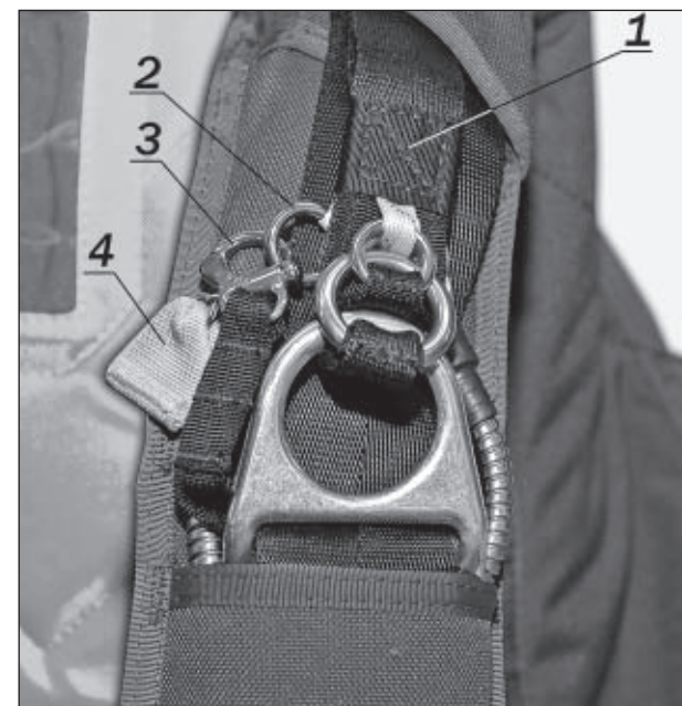
1 – левый свободный конец основного парашюта; 2 – кольцо; 3 – пряжка звена; 4 – лента раскрытия звена.
