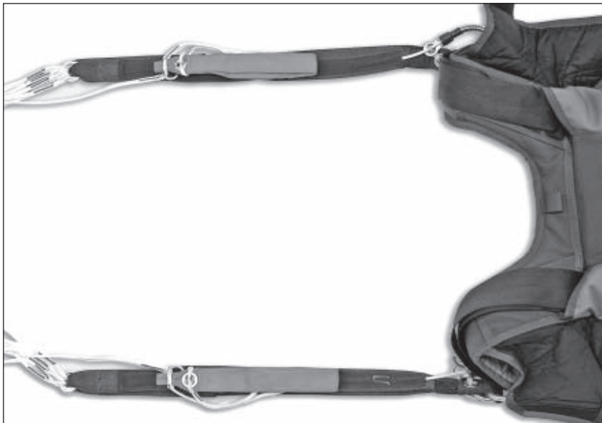
Рисунок 43 – Фиксация строп управления
