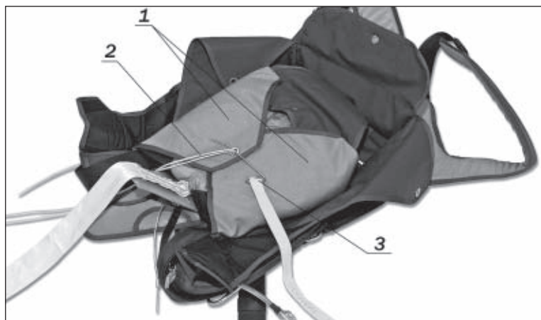
Рисунок 32 – Укладка парашюта в ранец
